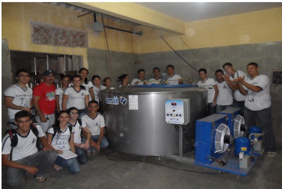
**Figura 12:** *Tanque resfriador de leite.*
