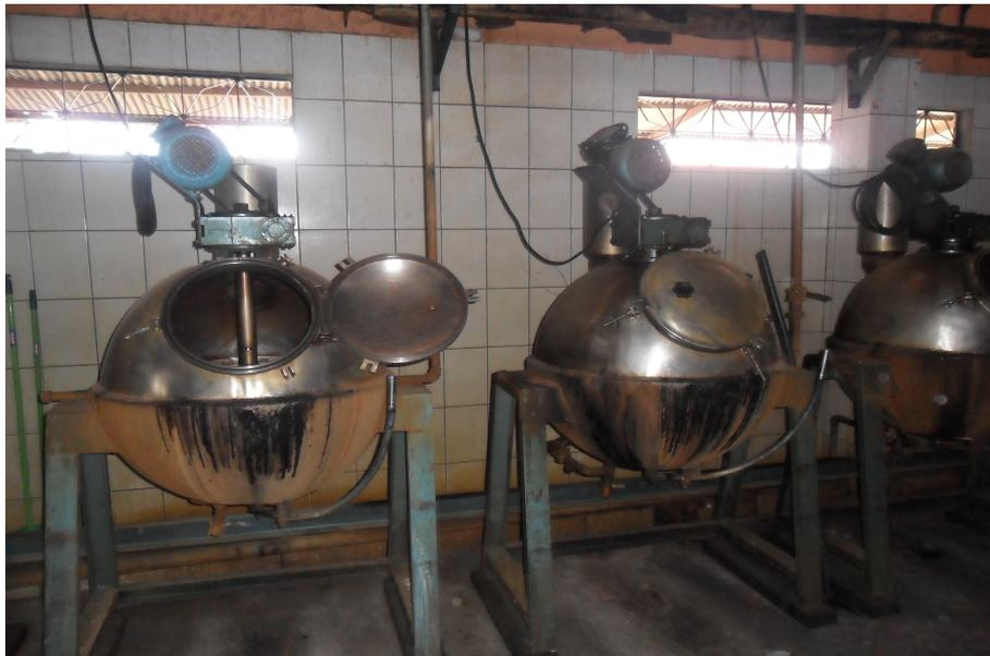
**Figura 23:** Tacho misturador esférico.
